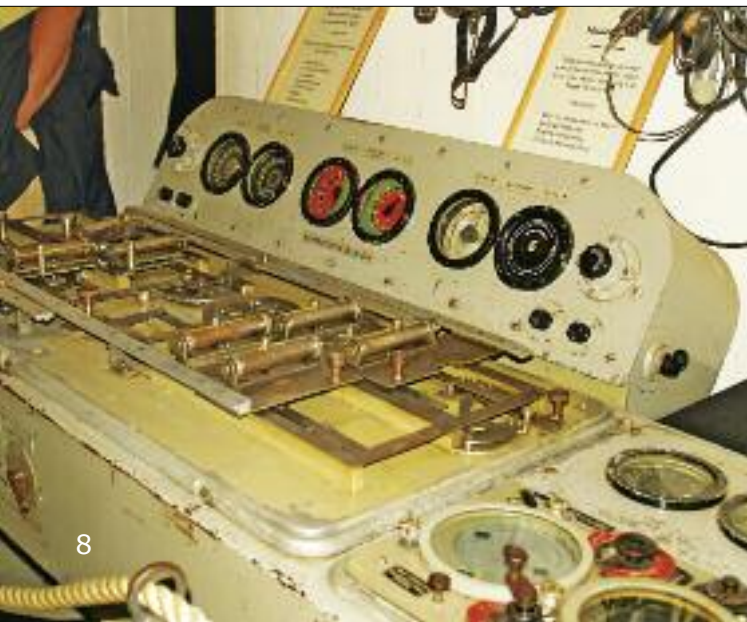
«Reknebord» til 10,5 cm kanonar (som ein lommekalkulator i høve til ein datamaskin).
